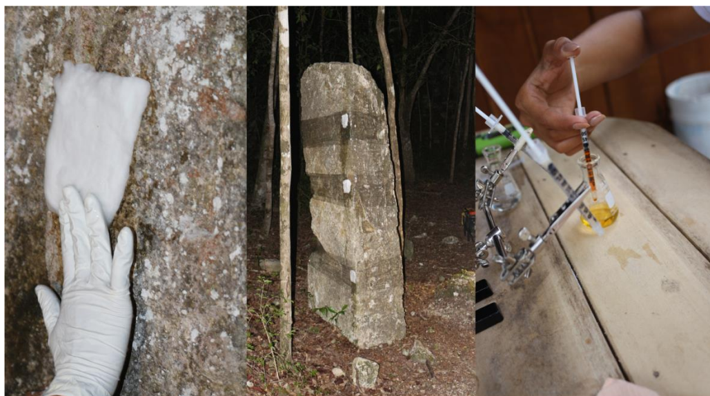
Figura 11.- Extracción de especies iónicas empleando papetas saturadas de agua desionizada, y análisis de acidez y alcalinidad in situ .
