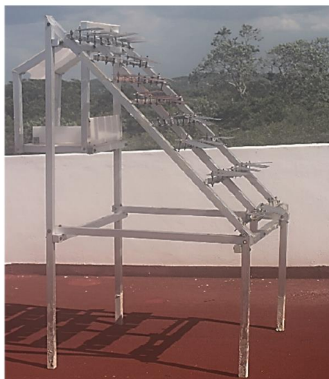
Figura 4. Unidad de exposición atmosférica en la estación Campus 6, en San Francisco de Campeche. Se pueden apreciar las probetas metálicas expuestas a la acción ambiental, y dispositivos pasivos para la medición de las tasas de deposición de SO 2 y aerosoles marinos.
